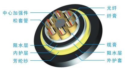
ADSS 光缆采用松套层绞式结构,将 250µm 光纤套入高模量材料制成的套管中,松套管内填充防水化合物。松套管(和填充绳)围绕非金属中心加强芯(FRP)绞合成紧凑的缆芯,缆芯的缝隙充以阻水油膏。缆芯外挤制聚乙烯(PE)内护套或耐电痕(AT)外护套。
